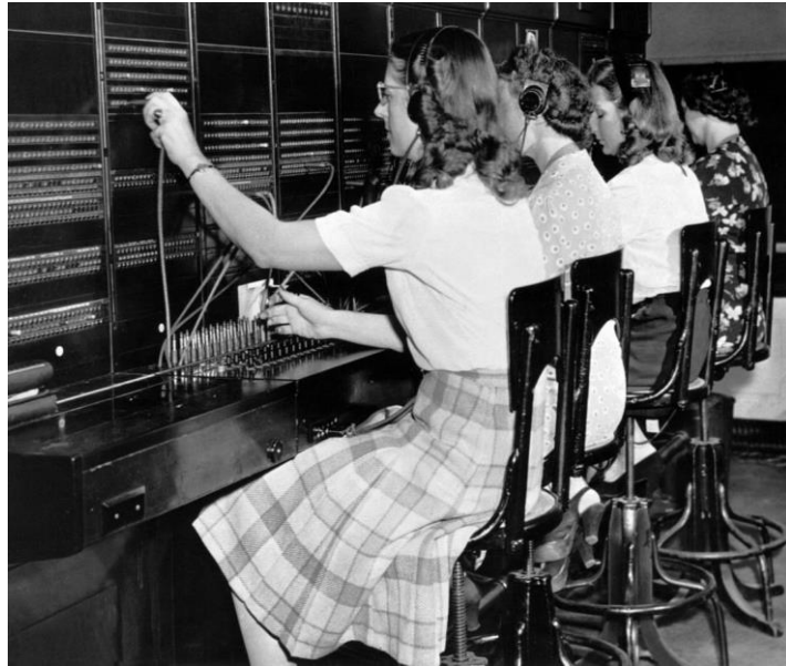
그림 2 탄나라 전화교환양 사진. 앞에 있는 패널(패치 패널이라고 부름)에 있는 구멍 각각이 가정의 전화기와 연결되었다고 보면 된다. 통화하려는 두 전화기 구멍을 손으로 잡고 있는 전선(패치 코드라고 부름)으로 서로 연결하면 두 전화기는 서로 연결된 상태가 된다. 3
